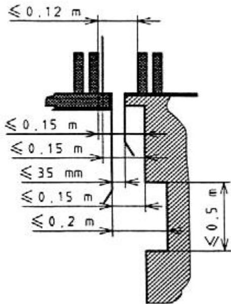
شکل ۴ : فواصل بین کابین و دیوار مقابل ورودی کابین
